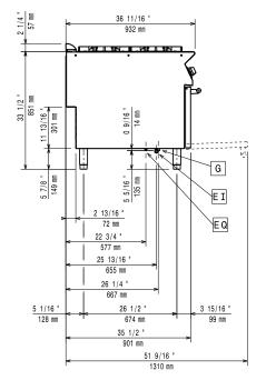
Electrical inlet (power) Equipotential screw Gas connection
